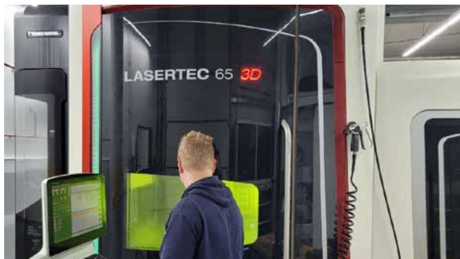
Über 25 Teilnehmer informierten sich beim Laborgespräch im 3D-Druckzentrum Soest. Neben verschiedenen Anlagen des Kunststoff-3D-Drucks waren die Anwendungsmöglichkeiten der Lasertec 65 3D Hybrid von großem Interesse, die ein 5-Achs-CNC-Bearbeitungszentrum mit 3D-Metallpulverdruck kombiniert. (Im Bild: Stefan Künne, Wissenschaftlicher Mitarbeiter im 3D-Druckzentrum)
