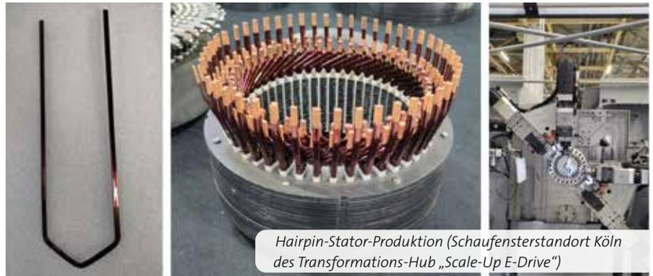
Hairpin-Stator-Produktion (Schaufensterstandort Köln des Transformations-Hub „Scale-Up E-Drive“)
